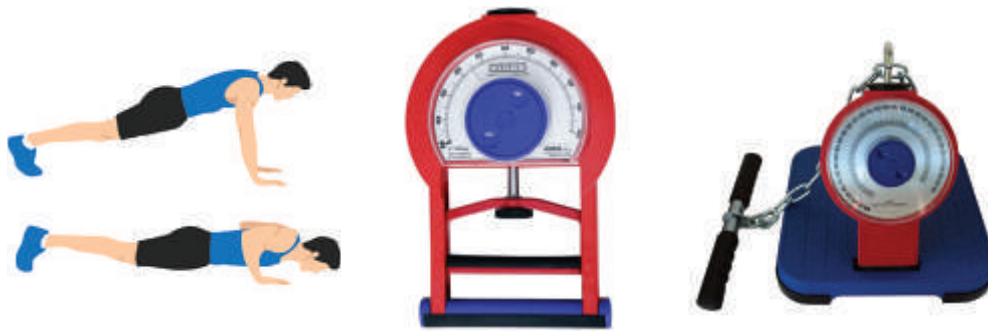
الشكل رقم (3-6) جهازي قياس قوة عضلات الرجلين، وقوة قبضة اليد، واختبار الضغط بالذراعين.
