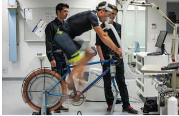
الشكل رقم (3-5) جهاز قياس الاستهلاك الأقصى للأكسجين (Vo2max).
