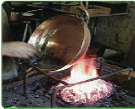
الشكل (٦٧): التخمير «تسخين المعدن لإكسابه اللدونة».
