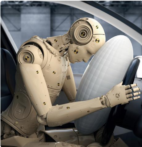
شكل 2.8: اختبار التصادم باستخدام دمية ثلاثية الأبعاد
