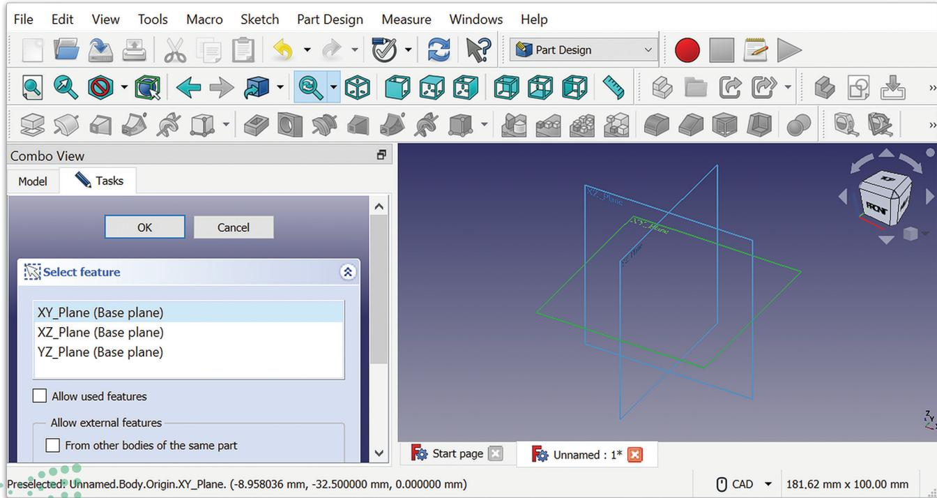
شكل 3.41: إنشاء رسم تخطيطي واختيار السطح XY
