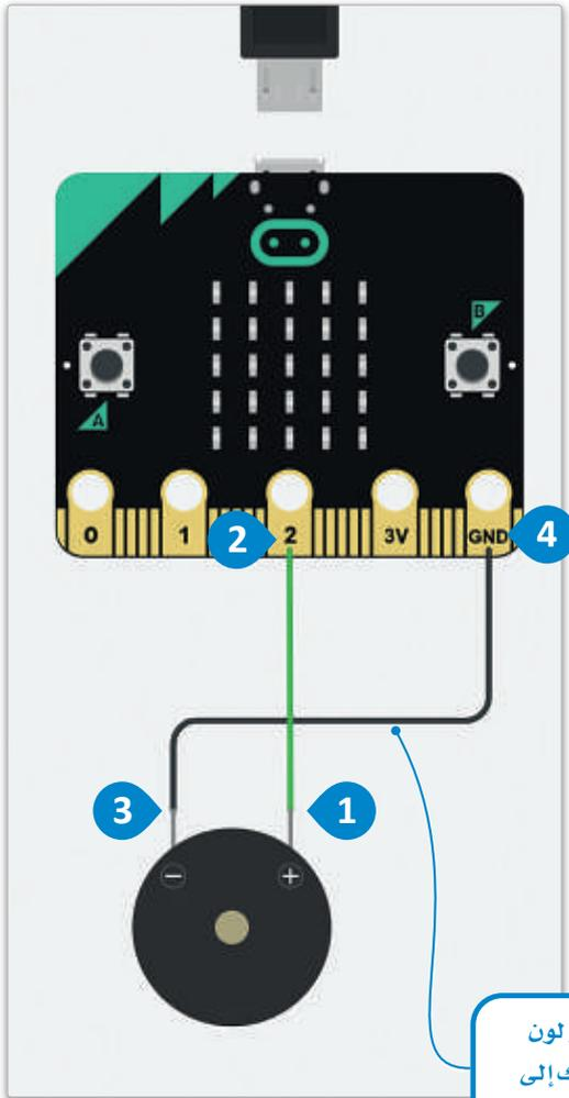
شكل 5.25: توصيل الطنان الكهربيائي
