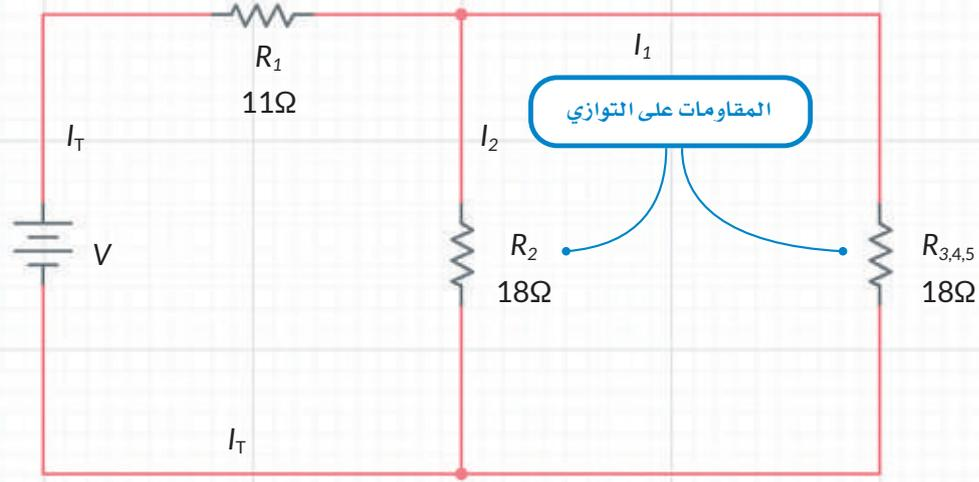
$$R_2 // R_{3,4,5} = \frac{R_{3,4,5} \times R_2}{(R_{3,4,5} + R_2)} = 9\Omega \text{ وعليه فإن:}$$
