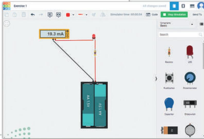
شكل 4.30: قياس التيار
