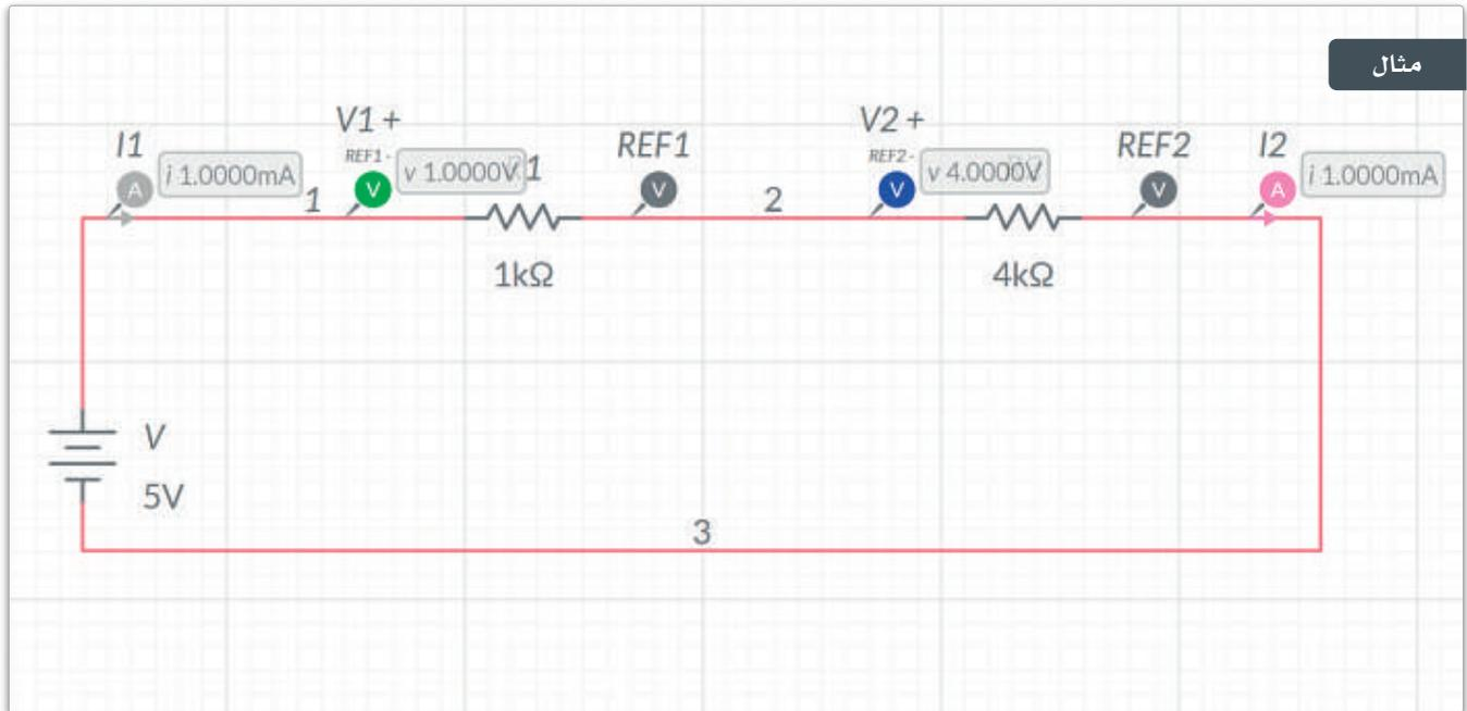
القيم التي تعرضها أدوات القياس تؤكد النتائج، وستلاحظ أيضًا أن جهاز الأميتر يعرضان شدة التيار ذاتها:
