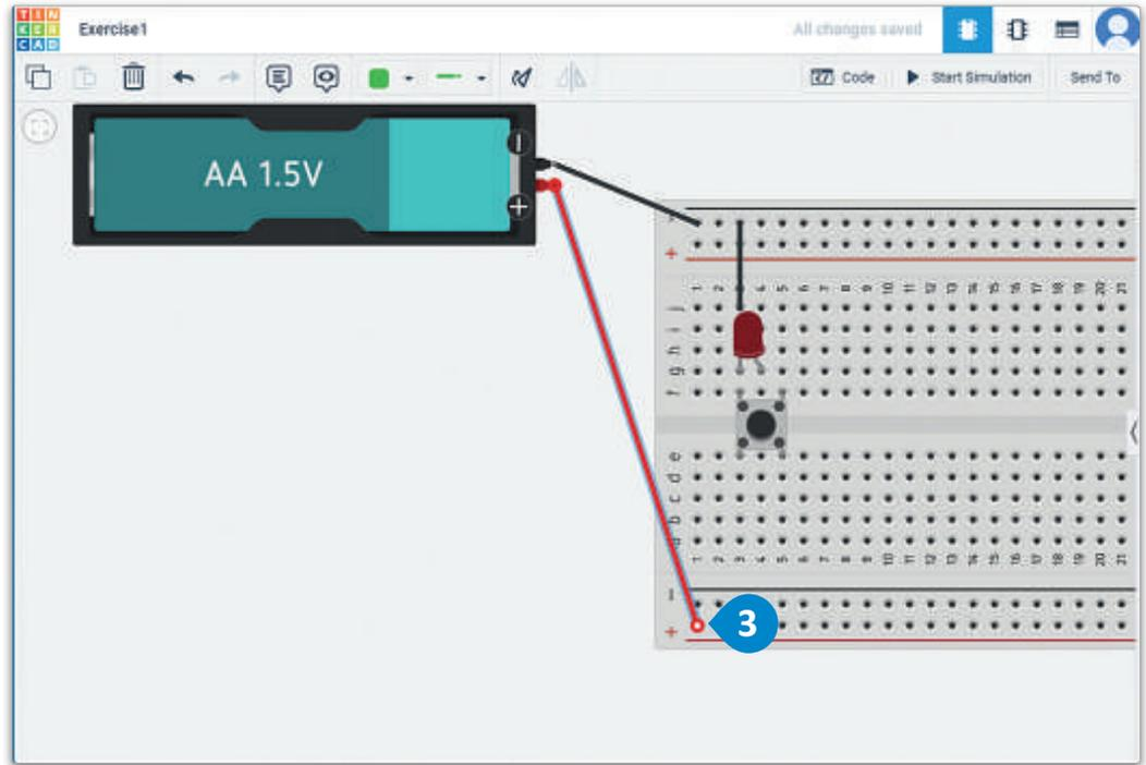
يتعين عليك كذلك توصيل القطب الموجب للدايود المشع للضوء بالطرف الموجب لمصدر التيار الكهربائي لتشغيل
