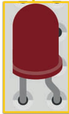
لا تعمل هذه الدائرة بشكل صحيح، ولذلك يتعين عليك توصيل مصعد الدايود المشع للضوء بالطرف الموجب لسريان التيار الكهربائي. من المهم الانتباه إلى أنه لا يمكنك نقل المكونات أثناء تشغيل محاكاة الدائرة.
