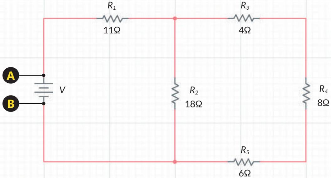
في البداية ستلاحظ أن المقاومات  $R_3$  و  $R_4$  و  $R_5$  تتصل على التوالي، لذلك تُحسب المقاومة الكلية كما يلي:  $R_3, R_4, R_5 = 4 + 8 + 6 = 18\Omega$
