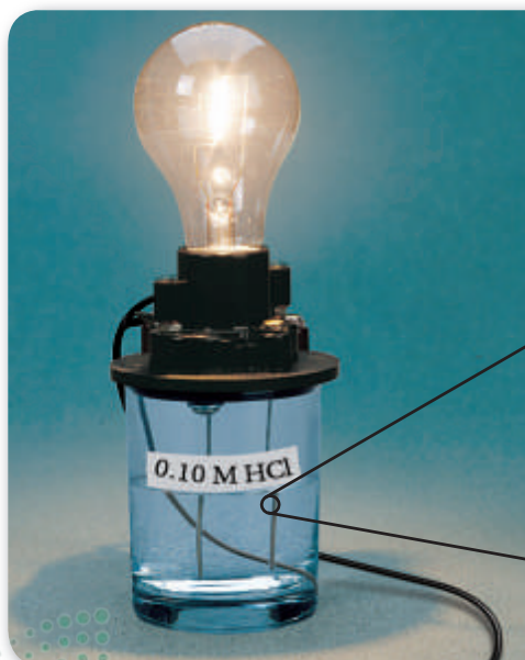
الشكل 2-11 يتوهج المصباح بقوة عندما يوضع القطبان في محلول حمض الهيدروكلوريك بتركيز 0.10 M؛ لأن جميع HCl تتحلل إلى أيونات هيدرونيوم وأيونات كلوريد.
