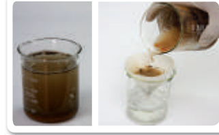
الشكل 1-1 يمكن فصل المخلوط المعلق إذا ترك دون تحريك فترة من الزمن، أو فصله بالترويق.
