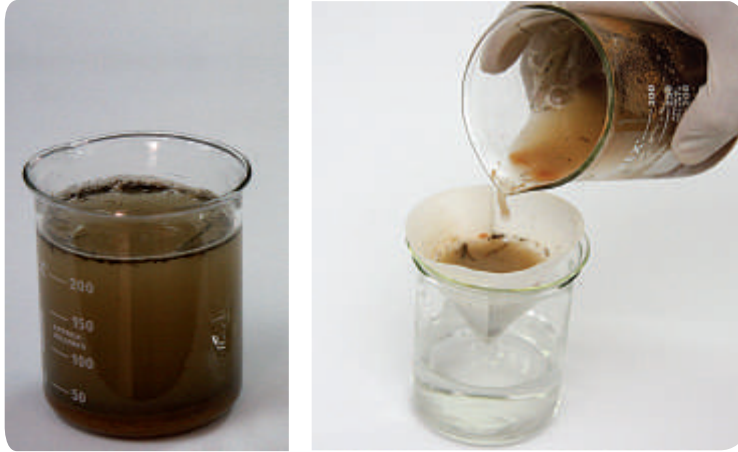
الشكل 1-1 يمكن فصل المخلوط المعلق إذا ترك دون تحريك فترة من الزمن، أو فصله بالترشيح.
