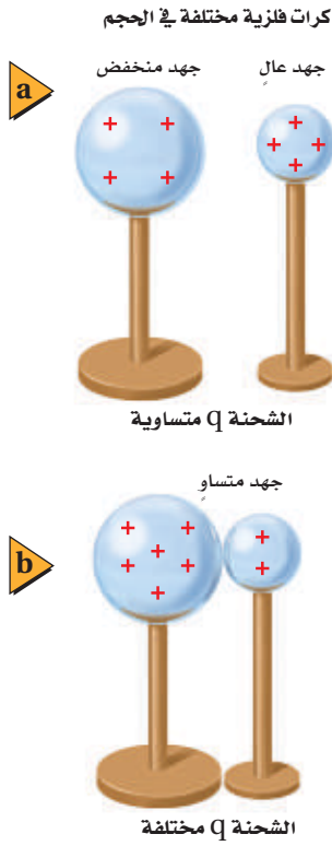
■ الشكل 9-12 تنتقل الشحنات من الكرة ذات الجهد الأعلى إلى الكرة ذات الجهد الأخفض عند تلامسهما، ويستمر انتقال الشحنات إلى أن ينعدم فرق الجهد بينهما.
