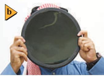
■ الشكل 18-4 عندما يتم ترتيب مرشحي استقطاب بحيث يكون محورا استقطابهما متوازيين، تنفذ من خلالهما أكبر كمية من الضوء (a). ولن ينفذ الضوء من خلال مرشحي الاستقطاب إذا تم ترتيبهما بحيث يكون محورا استقطابهما متعامدين (b).
