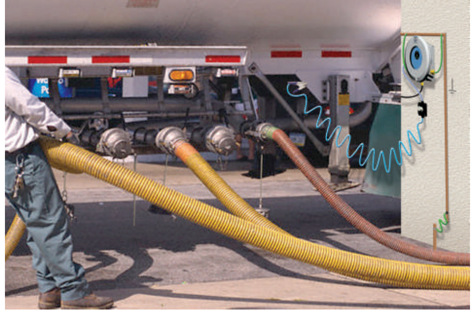
■ الشكل 9-13 سلك التأريض المتصل بصهريج نفط يمنع اشتعال بخار البنزين.
