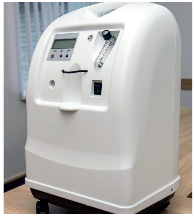
الشكل "57-3 ج" يزيل مولد الأكسجين الشوائب، والغازات الأخرى من هواء الغرفة ليركّز الأكسجين بالوحدة.
