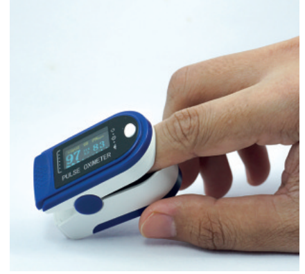
الشكل "3-58" يُستخدم مقياس التأكسج النبضي لقياس مستوى الأكسجين في الدم الشرياني.
