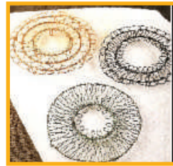
الشكل (٨٦): أسلاك رفيعة للربط
