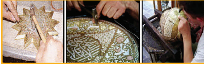
الشكل (٨١): طريقة التكفيت
