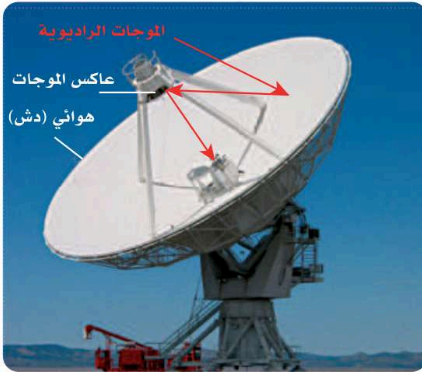
الشكل 14-3 تركيب المنظار الراديوي.
