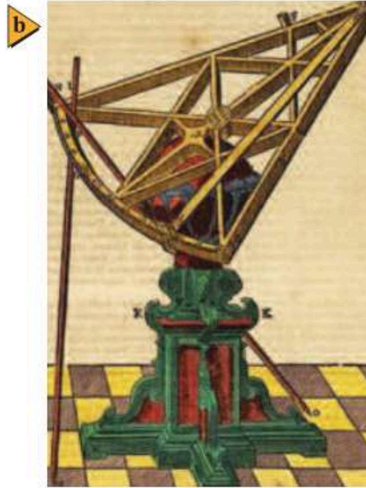
■ الشكل 1-1 من بين الأجهزة الضخمة التي بناها براهي واستعملها على جزيرة Hven جهاز الأسطرلاب (a)، وآلة السُّدس (b)، وهي في الأصل من ابتكار علماء المسلمين.
