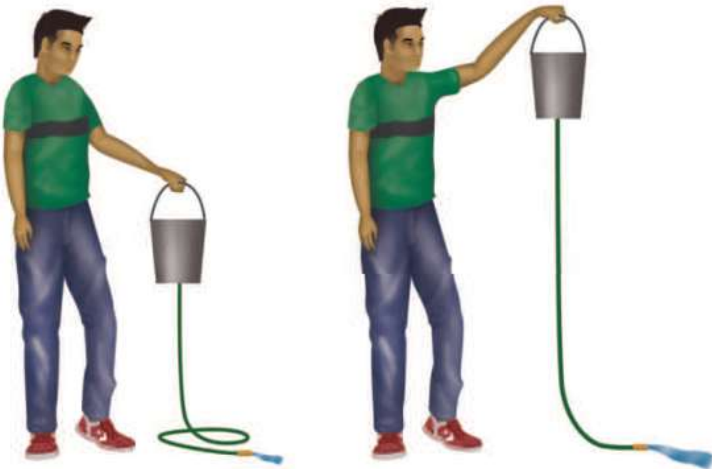
الشكل ١٠ عند رفع الدلو إلى أعلى يزداد مقدار طاقة وضع الماء داخله، مما يُسبب زيادة سرعة تدفق الماء الخارج من الخرطوم.
