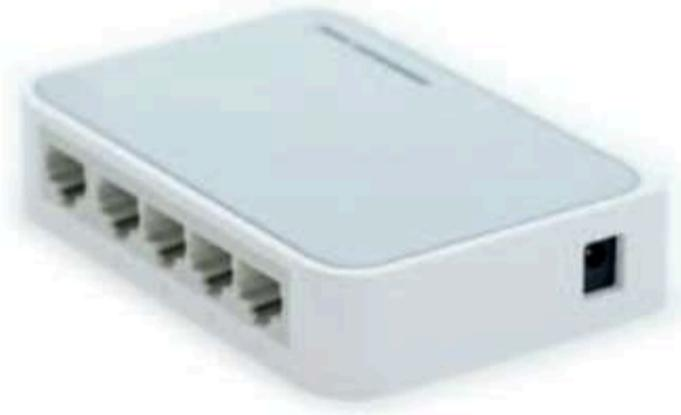
الموزع جهاز يصل عدة أجهزة داخل الشبكة المحلية، عندما يستقبل الموزع حزمة بيانات من جهاز متصل به، فإنه يبث هذه الحزمة إلى جميع الأجهزة المتصلة الأخرى بصرف النظر عن وجهتها النهائية.
