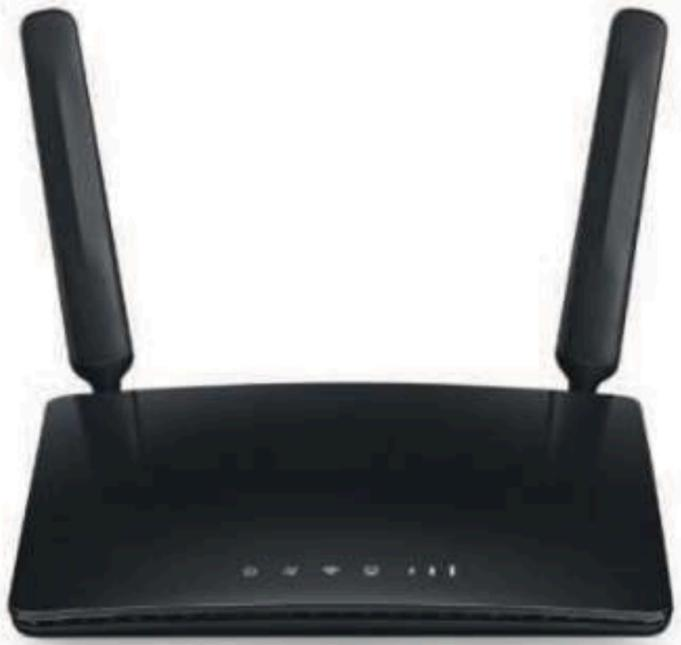
بوابة المنزل جهاز يُستخدم لتوفير خدمة اتصال **Wi-Fi** اللاسلكية للهواتف الذكية وأجهزة الحاسب النقالة والأجهزة الأخرى المزودة بإمكانات شبكة **Wi-Fi**. كما يمكنك استخدام بوابة **Gateway** وهو جهاز يجمع بين وظيفة المودم والموجه في نفس الصندوق، ويربط هذا الجهاز شبكتك بشبكة أخرى أكبر.
