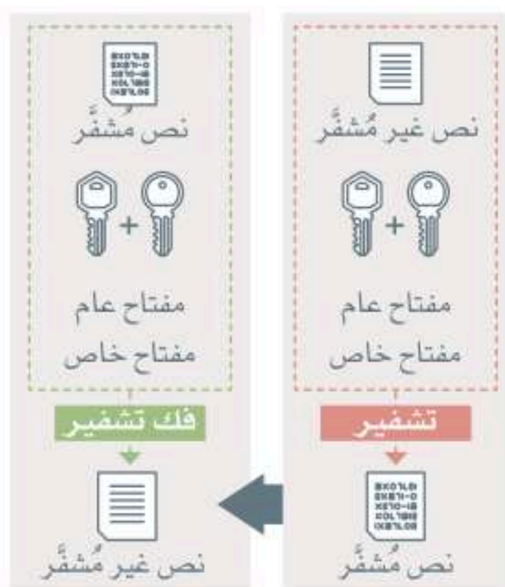
شكل 3.5: عملية التشفير باستخدام المفتاح غير المتماثل
