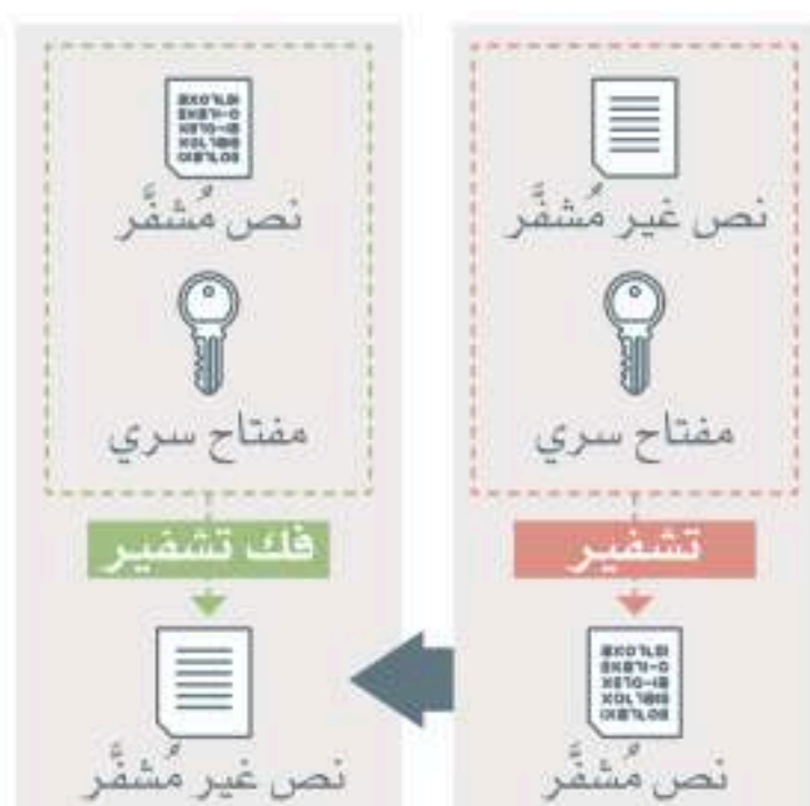
شكل 3.4: عملية التشفير باستخدام المفتاح المتماثل
