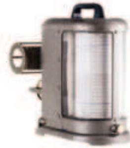
**الشكل 6-20** أحد أجهزة مقياس الزلازل (السيزمومتر) الحديثة.
