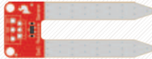
مُستشعر رطوبة التربة (Soil Moisture Sensor)
