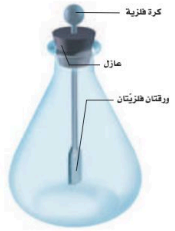
■ الشكل 2-8 الكشاف الكهربائي؛ جهاز يستخدم للكشف عن الشحنات الكهربائية. في الكشاف الكهربائي المتعادل تكون الورقتان معلقتين رأسياً بحرية، وتلامس إحداهما الأخرى.
