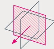
هذه بعض الأمثلة لكيفية استخدام أسطح العمل للرسم الهندسي في برنامج فري كاد، وهناك العديد من الميزات الأخرى التي تعتمد على برنامج التصميم المُستخدَم. تكمن الفكرة الرئيسية بأنه يُمكن استخدام كل سطح عمل للرسم الهندسي كسطح مرجعي لأغراض مختلفة. يُستخدم السطح XY بشكل أساسي لإنشاء الرسومات التخطيطية، ويُستخدم السطح YZ في الغالب للمحاذاة، بينما يُستخدم السطح XZ بشكل أساسي لإنشاء المقاطع العرضية.
