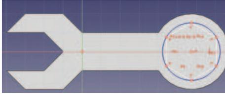
2 استخدم أداة إنشاء شكل سداسي (Create hexagon) لتصميم الشكل السداسي، ثم استخدم أداة التجويف (Pocket) لإنشاء ثقب سداسي الشكل في مفتاح الربط، ويجب أن يكون سُمك المفتاح 5 ملليمتر.
