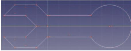
1 استخدم أداتي إنشاء خط (Create line) وإنشاء خط متصل (Create polyline) لإنشاء محيط مفتاح الربط. استخدم أداة إنشاء قوس (Create arc) لإنشاء هيكل مفتاح الربط.
