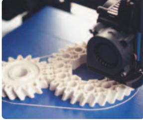
شكل 3.5: تروس تم إنتاجها بواسطة طباعة سوداء صغيرة تعمل بتقنية نمذجة الترسيب المنصهر
