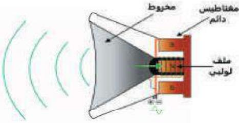
تعمل السماعة على تحويل الطاقة الكهربائية إلى .....
