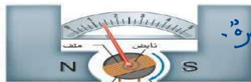
استخدامه: هو جهاز يستخدم لقياس التيارات الكهربائية الصغيرة.
