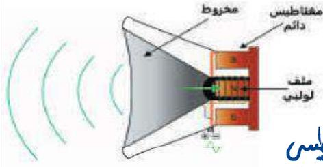
تعمل السماعة على تحويل الطاقة الكهربائية إلى طاقة صوتية.....
