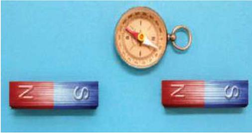
نشاط ①: من خلال التجربة الاستهلاكية: في أي اتجاه تؤثر المجالات المغناطيسية: سؤال التجربة: ما اتجاه القوة التي تؤثر في جسم مغناطيس في مجال مغناطيسي؟ الهدف من التجربة: إثبات أن المغناطيس يولد مجالاً مغناطيسياً حوله. النتائج: أن المجال المغناطيسي يولد قوة تؤثر في المغناطيس الأخرى. فتتجاذب الأقطاب المغناطيسية المختلفة وتتنافر الأقطاب المغناطيسية المتشابهة.
