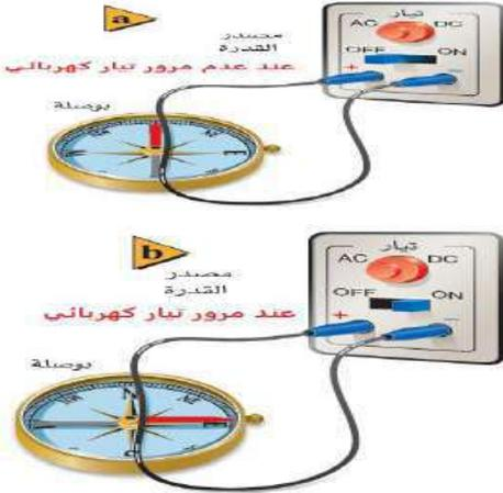
نشاط ①: أجرى العالم أورستد عام ١٨٢٠م تجارب على التيارات الكهربائية المارة في الأسلاك، بوضع سلكاً فوق محور البوصلة الصغير وأوصل نهايته بدائرة كهربائية مغلقة.
