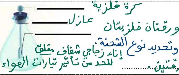
استخدامه: للكشف عن الشحنات الكهربائية وتعدد نوع الشحنة
