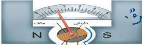
استخدامه: هو جهاز يستخدم لقياس التيارات الكهربائية الصغيرة.
