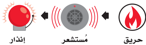
شكل 5.2: نظام إنذار الحريق
