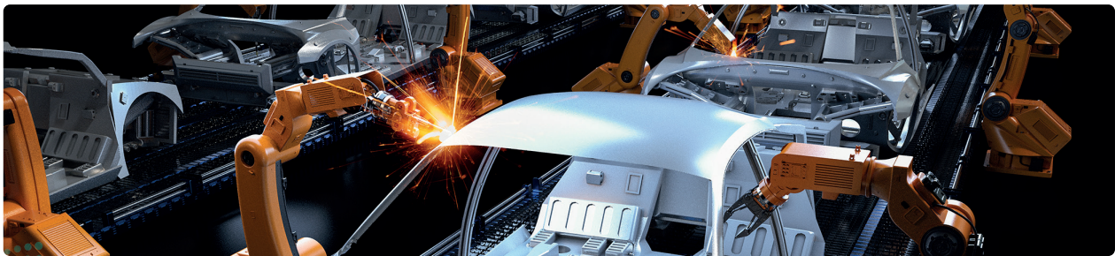
شكل 1.4: خط تجميع روبوتي في مصنع سيارات
