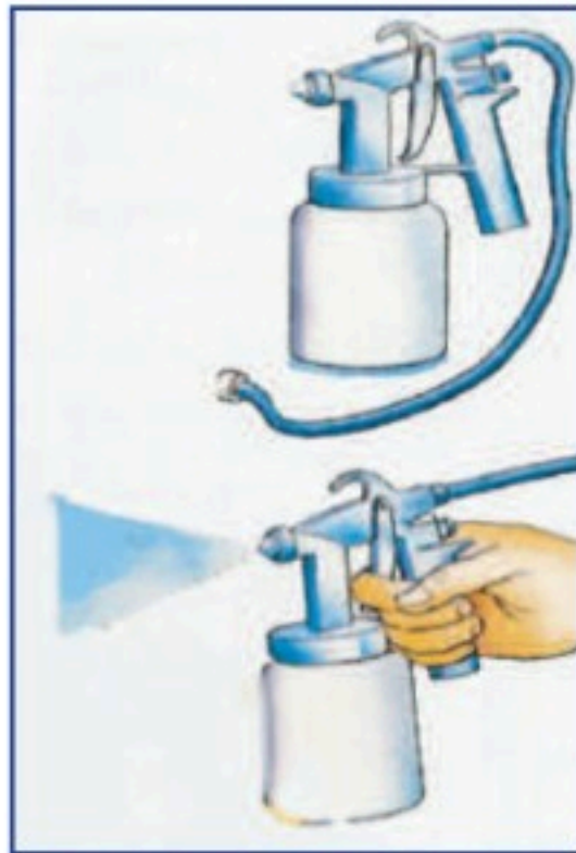
الشكل (١١): بخاخة موصلة بمضخة.
