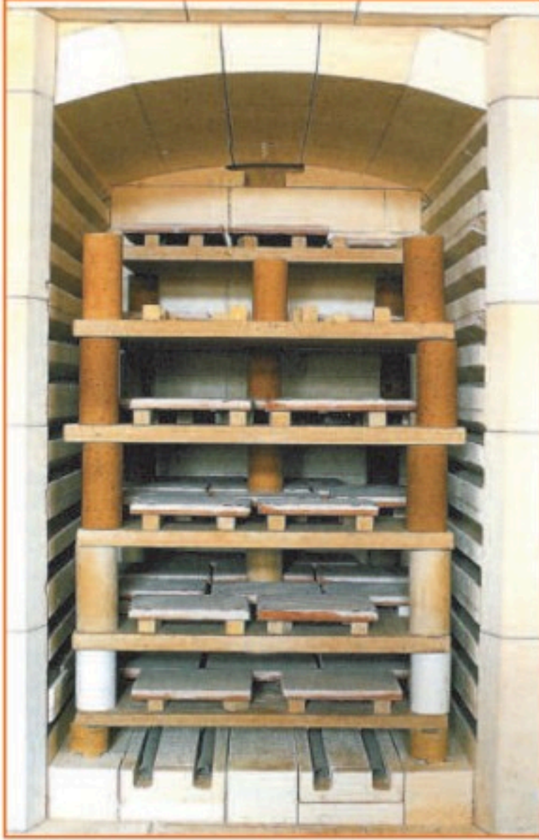
الشكل (٣٦): طريقة رص القطع الطينية في الفرن الكهربائي.
