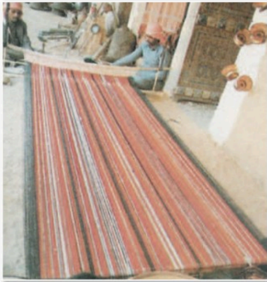
الشكل (٩): نول أرضي لإنتاج قطعة كبيرة.
