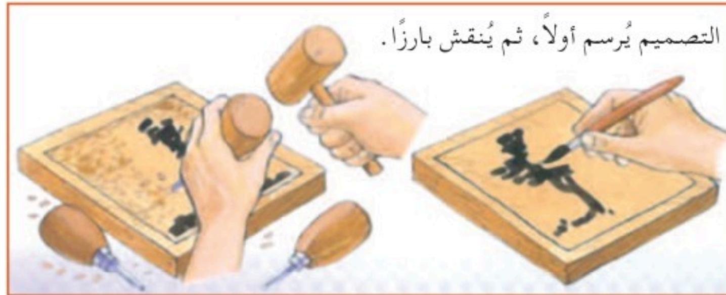
الشكل (٩٣): طريقة تنفيذ الإشارات بالحفر على الخشب.
