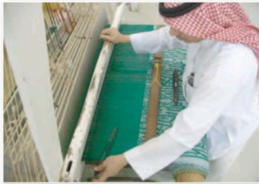
الشكل ( ٦ ) : نلاحظ كيف يمرر النساخ المكوك .
