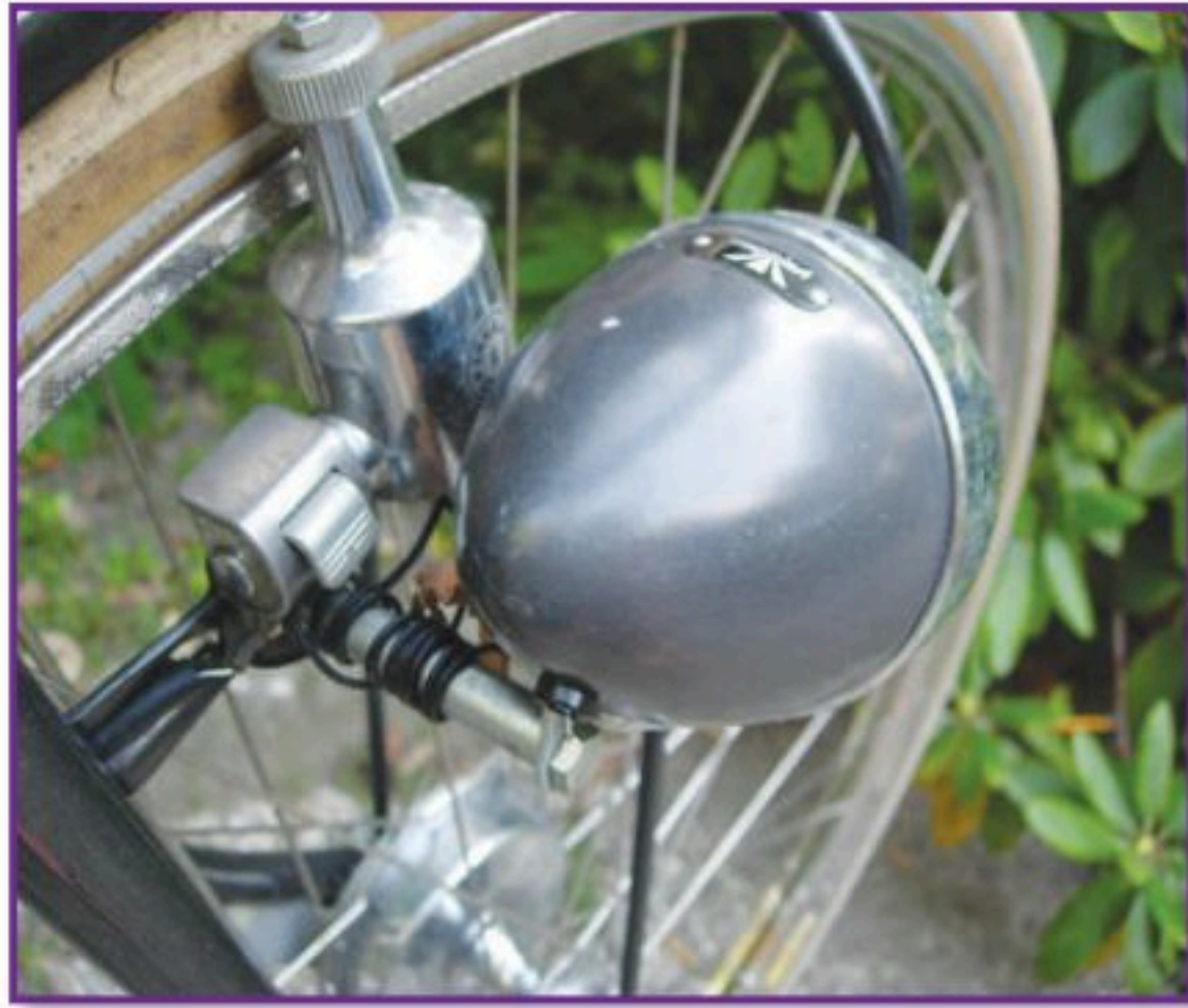
يتصل المولد الكهربائي بعجلة الدراجة
