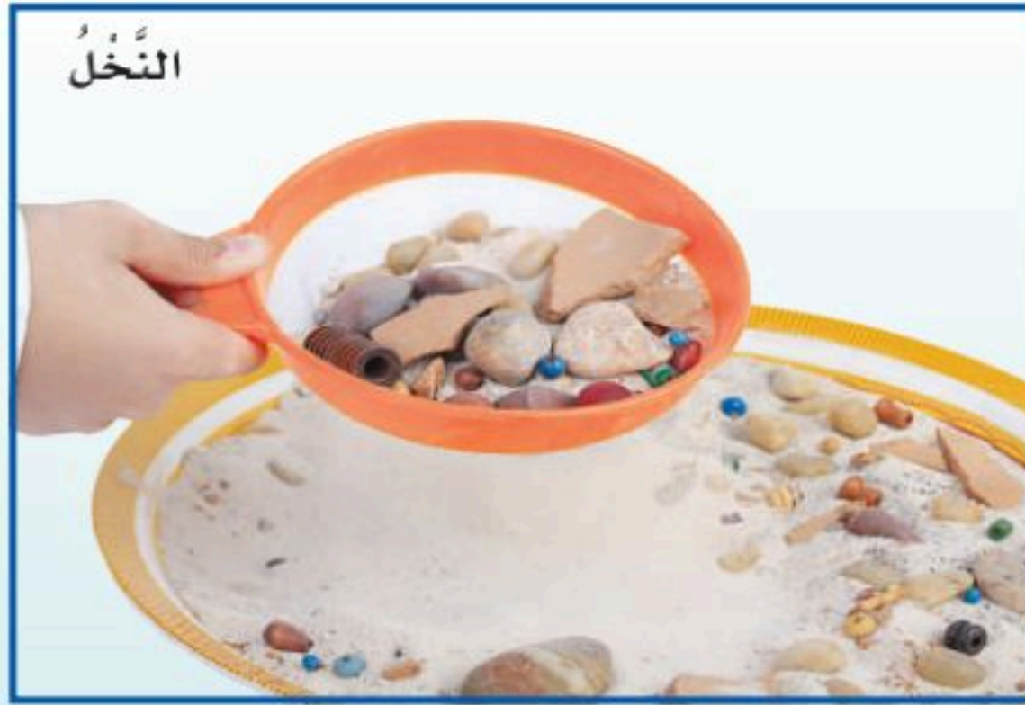
يستخدم المنخل لفصل مواد مختلفة الحجم.
